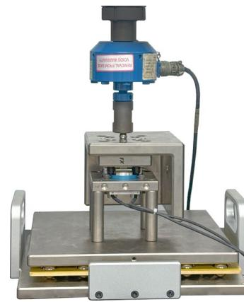
力传感器标定设备（以下简称“设备”）是一套开发的力传感器标定平台，既支持通用的力传感器标定，也支持汽车碰撞试验用假人内置力传感器标定。其他特殊的传感器标定模块，也可基于此平台定制开发。设备默认支持应变式力传感器标定，也支持带放大器的测量链式力传感器标定；对于压电式力传感器，可通过配合电荷放大器实现标定。设备主要包括电子万能试验机，参考力传感器，数据采集装置，传感器信号转接盒，标定夹具（可定制）和操作软件。
