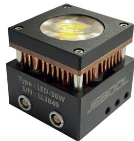
车载补光灯 LED-36W 采用大功率 LED 矩阵式灯珠，实现了较高的电流至光通量转换效率。LED 矩阵直接安装在铜柱式散热器上，加上高速风扇，实现了良好的散热效果。
