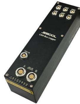
车载总线记录仪 CANLogger-6FD, 主要应用于汽车碰撞试验中, 对车辆 CAN 总线数据进行采集, 并提供 T0 时刻标记。按 6 通道 CAN-FD 设计, 并兼容普通高速 CAN, 波特率可以在软件中设置。设备采用总线连接, 碰撞前设置各个通道的波特率, 启动 ARM (或 SR 触发), 试验后下载数据即可, 操作简单。
