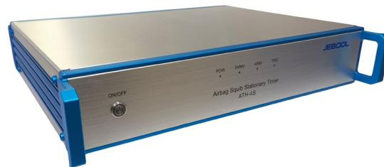
气囊静态点爆器 ATH-4S，主要应用于汽车安全气囊、安全带和发动机罩举升器的点爆试验。该点爆器配置有触发输入和多路触发输出，可用于高速相机、数据采集设备等触发；配有多路 IO，可用于灯光、抽风、门禁等逻辑控制；配有多路模拟量输入，可同步采集点爆时压力、加速度、力等传感器信号。
