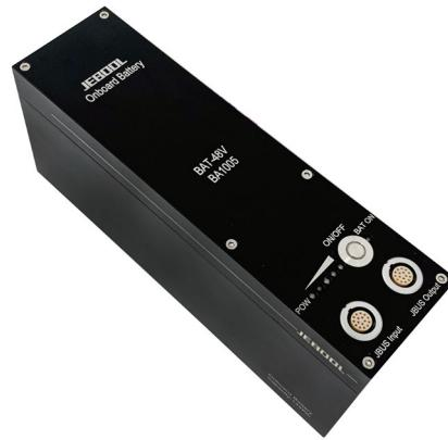
车载电池 BAT-48V，采用功率型锂电芯设计，充满电时 52-54V，放电截至电压≤36V。内置了 UPS 自动旁路电路，当外部电源大于旁路阈值时，自动切换为外部电源供电；当外部电压大于充电阈值时，将自动对电池进行充电，同时外部电源也作为输出电压直接向负载供电；电池充电电流≤2A，支持外部最大输入电压 54V。设备内置电池均衡和温度保护功能，电池输出指示灯和电量显示指示。
