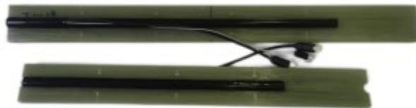
腿骨总成包含腿骨本体，应变计，补偿电路，线缆和接头组成。应变计中心位置与 ECE R127 规定力矩测量点一致。腿骨采用高韧性纤维材料，应力应变呈现高线性，以及迟滞优异性能。完全满足行人保护下腿型腿骨性能要求。应变计在大变形下同时保持了良好的线性度，桥路采用中心冗余走线方式，并通过耐高温硅胶条保护。
