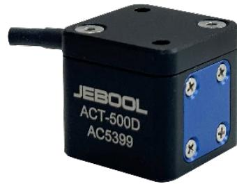
ACT-500D 集成了 3 轴加速度和 3 通道的 ADM 数字化模块, 实现了加速度数据一体化采集, 通过 DDAS 总线控制和数据传输。其内部包括一个高精度 LDO 稳压和硬件抗混叠低通滤波电路, 实现了加速度信号的精密测量。ACT-500D 配有高性能耐磨线缆, 通过 2 个安装孔来固定, 可以根据客户需要, 来配置接头。
