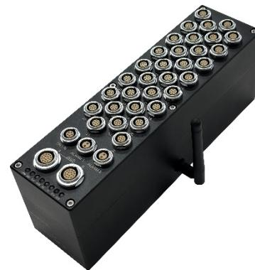
氢燃料汽车泄漏测试仪 FCV-32C 为氢燃料汽车碰撞试验中安全监测设计。试验时可通过 WiFi 实时查看数据，监测碰撞安全性。通过霍尔电流传感器隔离监测瓶阀状态。FCV-32C 支持外部开关触发及 JBUS 总线差分触发。设备与车辆储氢系统连接时，需要通过三通线缆，串接到车辆压力和温度传感器接口。同时，设备支持与氢气浓度传感器 H2-5C 或氦气浓度传感器 He-5B 连接。设备内置锂电池，支持 100Hz 数据记录及 Ethernet 数据通讯功能，数据提供多种格式。
