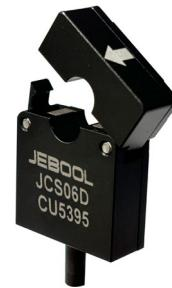
电流传感器 JCS06D 基于霍尔原理，实现对线上电流的高精度测量。独立的供电与测量系统完全隔离，直接输出电压信号与被测电流有较好的线性关系。JCS06D 配有高性能耐磨线缆，线缆长度可以定制。另外，可以根据客户需要，配好 Dallas ID 和接头。
