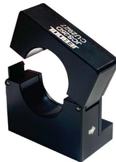
电流传感器 JCS25D 基于霍尔原理，实现对线上电流的高精度测量。独立的供电与测量系统完全隔离，直接输出电压信号与被测电流有较好的线性关系。默认量程 500A，其他量程可定制，最大 1000A。JCS25D 配有高性能耐磨线缆，线缆长度可以定制。另外，可以根据客户需要，配好 Dallas ID 和接头。
