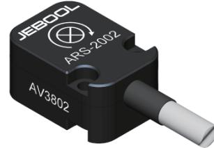
角速度传感器 ARS-2002 基于谐振器陀螺仪原理，内部包含多个振动构架，当检测结构旋转时，产生的科氏力来改变一个电容结构，进而转换为电信号变化，从而实现了角速度测量。独立的供电与测量系统完全隔离，直接输出电压信号与被测电流有较好的线性关系。ARS-2002 配有高性能耐磨线缆。另外，可以根据客户需要，配好 Dallas ID 和接头。
