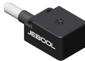
压力传感器 DP200K 基于压阻原理, 内部包含一个全桥电路, 当检测到外部气压变化时, 内部桥路电阻发生变化, 进而转换为电信号变化, 从而实现气压测量。内部可靠精密的 MEMS 工艺, 保证了输出电压信号与被测电流有较好的线性关系。DP200K 配有高性能耐磨线缆, 可以用双面胶粘接也可以使用螺丝或铆钉来固定。另外, 可以根据客户需要, 配好 Dallas ID 和接头。
