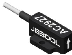
AC-100 是基于 MEMS 压阻原理，实现超低噪声，重复性高的单轴加速度传感器。内部包括一个高精度 LDO 稳压，从而降低对外部电源的要求。加速度内部均集成去耦合低通滤波器。AC-100 配有高性能耐磨线缆，可以用双面胶粘接也可以使用螺丝或铆钉来固定。另外，可以根据客户需要，配置 TEDS 和接头。
