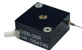
位移传感器 DSS-35，内部包含一个可调电位计，并同轴设计钢丝线圈，当钢丝拉伸或收缩时，电位计阻值随之变化，其内部独特的设计，使得位移量与输出电压保持了良好的线性关系。钢丝采用 304 不锈钢材料，及大张力设计，非常适用于高速测量应用，如汽车碰撞假人膝部位移，汽车行人保护腿型膝部韧带拉伸，以及航空机载设备状态监测。
