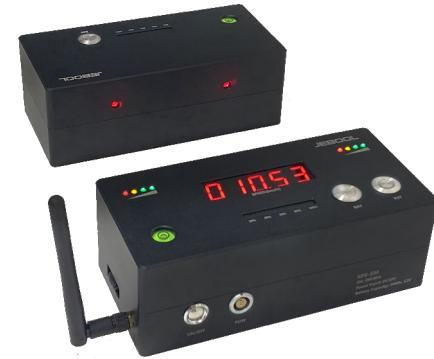
速度测量系统 SPS-5M，采用高速，远距离激光传感器，前后 2 组对射安装。通过检测物体穿过 2 组激光传感器的时间差，来计算速度。使用时，通过可见光斑及 LED 显示来进行位置调整。测速仪支持无线复位功能，启动后显示上次测速值，复位后进入 ARM 状态，当物体进入传感位置即触发测量，通过后立即显示速度结果。测速仪 SPS-5M 提供标准三脚架安装接口，非常方便安装和位置调整。
