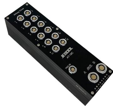
车载气囊定时点爆器，主要应用于汽车碰撞试验或模拟台车试验中气囊（发生器）的定时点爆。AT-16C 具有 16 个点爆通道，单个可以满足大多碰撞试验需求；每个通道均可独立设置，并且通过各自的指示灯，实时显示连接气囊状态。设备内置 UPS 电池及各通道独立的点爆电容，同时可对点爆电流和电压进行数据采集。外部采用 JBUS 总线连接，并设置有独立的触发输入口，整体操作简单。
