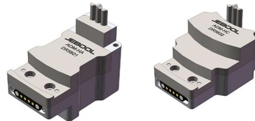
数据采集器 ADM-HA 和 ADM-HC 专为汽车安全测试中，行人保护试验用头型数据采集设计。其满足 C-NCAP, GB24550 和 UN R127 相关技术要求，以及 SAE J211 和 ISO 6487 数据采集装置要求。该数据采集器包含了头型背板（分成人和儿童两个版本），使用时，直接更换背板即可完成安装。装置采样磁性插座接口，试验室，头型发射过程中，磁性插头自动脱离，数据采集器自动触发。试验后，从新接回线缆进行数据下载。从而实现头型碰撞时的无线数据采集。
