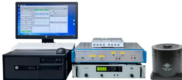
加速度传感器标定系统 SCS-ACV 是按照 ISO16063-21 标准进行设计，按常用的中频段（20Hz~5kHz）进行配置。系统选用 BK4808 型激振器，适合小质量中频加速度标定，在无冷却的情况下推力可达 112N；标准加速度传感器采用 Endevco 2270，其谐振频率均大于 35kHz，并具有极低的温漂（<3%, -40°C~120°C）和长期稳定性。系统采用软件自动控制，标定报告自动生成，报告模板可按要求定制。
