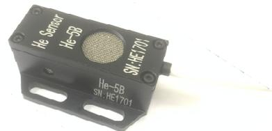
氦气传感器基于气体导热原理，实现空气中氦气浓度的检测。其内部使用的气体导热传感器，采用 MEMS 加工技术，利于被测组份和参考气体的导热响应。传感器内部运用运放反馈和偏置电路，减少了温度对信号的影响，改善了传感器的线性度。传感器配有高性能耐磨线缆，长度可以定制。可选配 Dallas ID 和接头。
