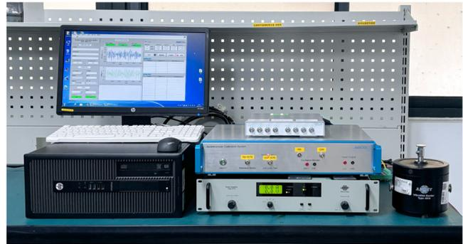
加速度传感器标定系统 SCS-ACV 是按照 ISO16063-21 标准进行设计, 按常用的中频段 (25Hz~5kHz) 进行配置。系统选用 BK4809 小型桌面式激振器, 适合小质量中高频加速度标定, 如需更大推力可改为 BK4808 激振器推力提升至 112N (20Hz~5kHz); 标准加速度传感器采用 Endevco 2270, 其谐振频率均大于 35kHz, 并具有极低的温漂 (<3%, -40°C~120°C) 和长期稳定性。系统采用软件自动控制, 标定报告自动生成, 报告模板可按要求定制。
