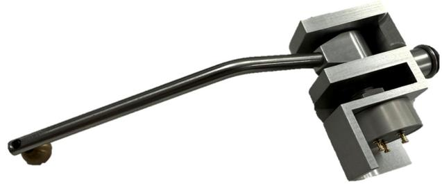
H3CHP-ASS 专用于 H3 假人用胸部位移测量，其核心采用高性能电阻式电位计，具有出色的非线性度，保证了整个组件位移测量的准确性。电位计和安装组件采用定位销定位，并通过锁紧螺母固定，防止电位计滑动影响灵敏度。可根据 H3-5<sup>TH</sup> 和 H3-50<sup>TH</sup> 假人，提供配套规格。默认线长 8 米，可按客户要求提供接头和 ID 芯片。另外可提供数字化 DDAS 版本。
